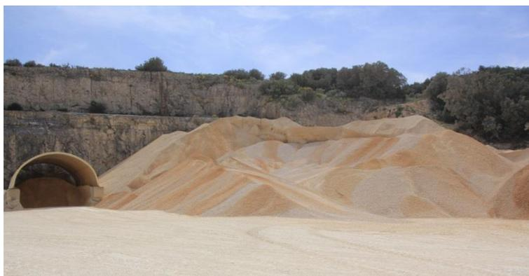
Le projet d'installation de lavage des granulats permettra de produire également du sable 0/4 lavé, et ce à la demande des clients. Ce produit sera stocké sous tunnel ou dans une trémie d'alimentation pour éviter le dépôt de fines qui « annulerait » l'effet du lavage.
