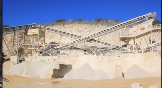
Photographie de l'installation de traitement secondaire (concasseur PP1010NG et crible CK1004)
